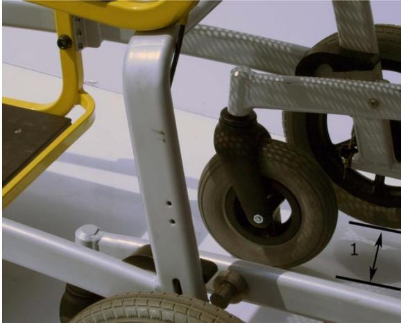
Heben Sie den Caddy<sup>3</sup> an der Rückseite an und schieben die Schelle über die Nocke des Caddy e-Move, bis diese an beiden Seiten festsetzt. Die Hinterreifen des Caddy<sup>3</sup> haben nun keinen Bodenkontakt mehr.
