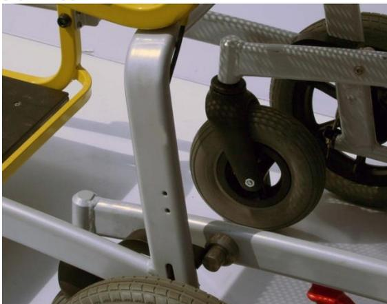
Positionieren Sie die Koppelschelle des Caddy<sup>3</sup> direkt vor der Koppelnocke des Caddy e-Move.
