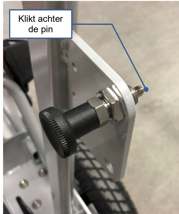
Veerknop; bij het opklappen van het plateau klikt het achter de pin van de veerknop
